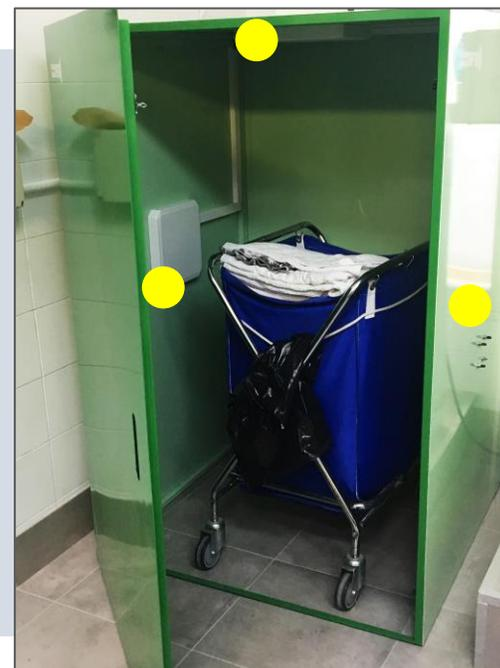
● Con configuración interna del sistema de antenas RFID
